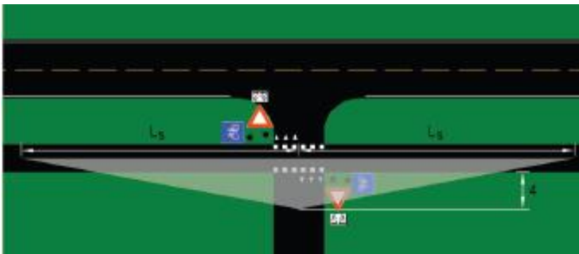
Figur 4: Siktkrav i kryss mellom gang-/sykkelvei og avkjørsel. Stoppsikt ( L_s ) I dette tilfellet vil være 35 meter
